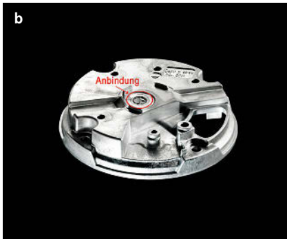
Bild 3: Motorenabdeckung für Ventilatoren; a) konventionell hergestellt mit langem Anschnittsystem, das abgetrennt und wieder eingeschmolzen werden muss, b) mit der Heißkanaltechnologie hergestellt; der Anschnitt sitzt platz- und materialsparend direkt mittig auf dem Gussstück.
