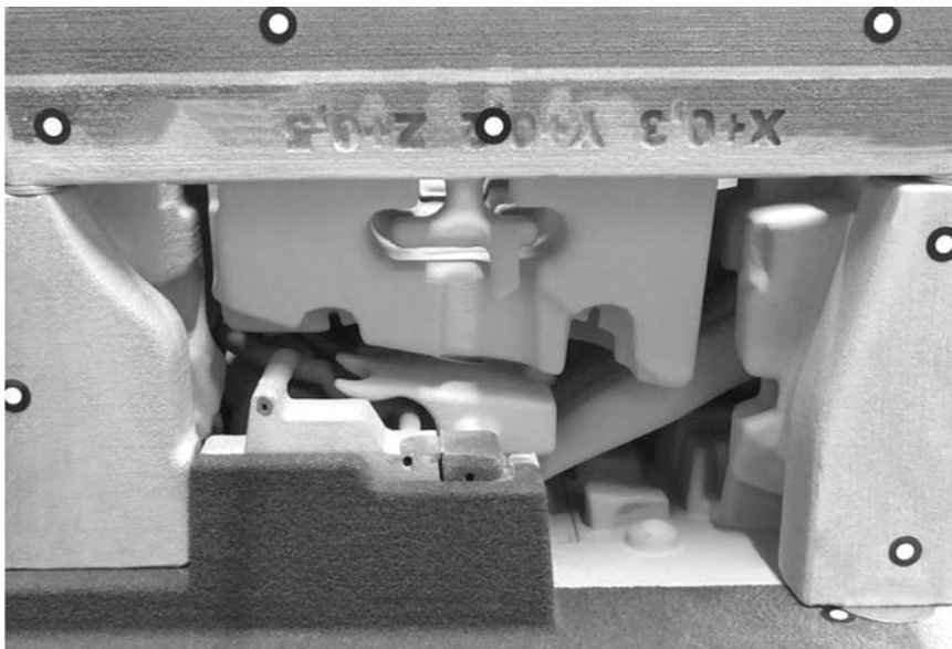
Bild 5: Kernpaket für Zylinderkopf mit Dampf- und Isolationskern.
